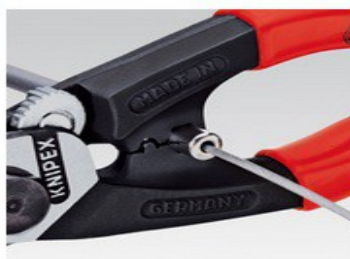
Пресоване на гилзата към кожата на спирачното жило
